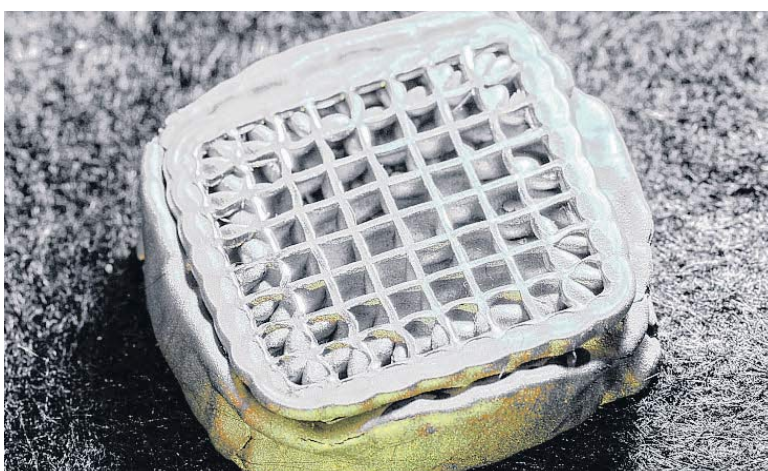
Der verformte Wabenkörper zeigt, dass der neuartige Werkstoff gut Energie aufnehmen kann, etwa bei einem Aufprall. FOTO: TU BERGAKADEMIE FREIBERG
