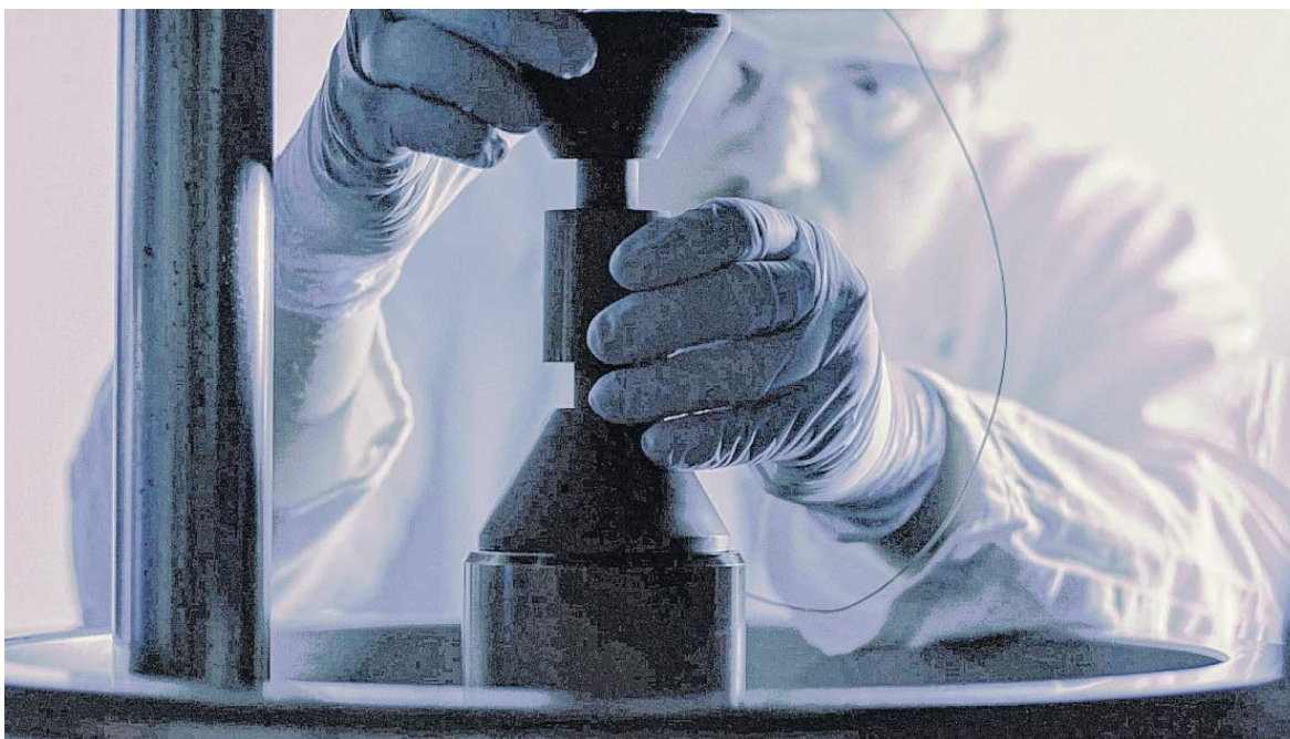
Ein Mitarbeiter der TU stellt eine Probe in der Sinteranlage ein. Dort wird das Material bis unter den Schmelzpunkt erhitzt, sodass sich die Stahl- und Keramikpulver in einen festen Stoff umwandeln. FOTO: TU BERGAKADEMIE FREIBERG
