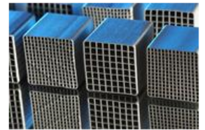
Verbundwerkstoff aus Stahl und Keramik © TU Bergakademie Freiberg/ IKGB
