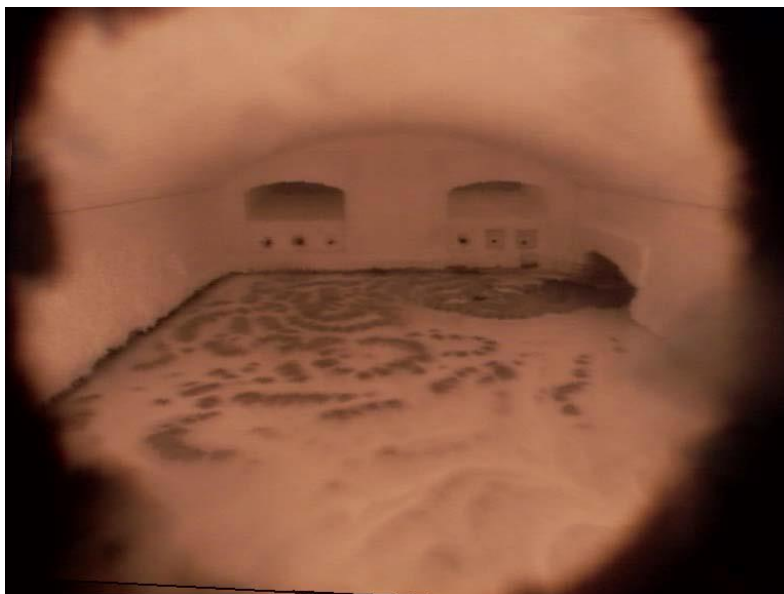
Offenkamerabild einer U-Flammenwanne mit Schaumschicht
