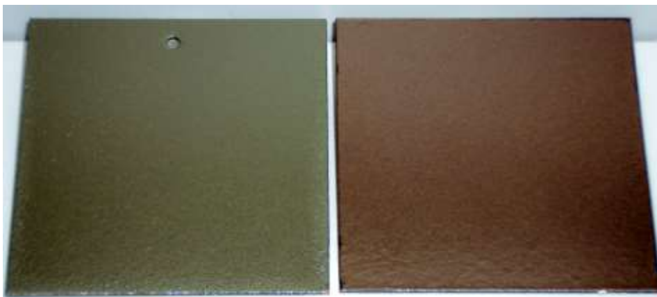
Bild 2: emailierte Probebleche vor und nach dem Test ( 1000\text{ °C} , 30 min)
