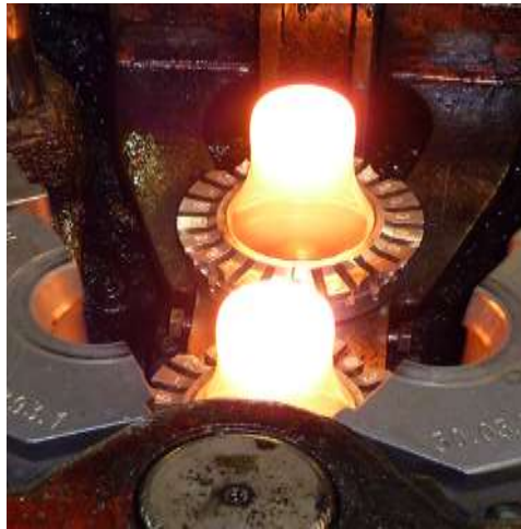
Einsatz von Aluminiumguss als Mündungsmaterial bei der Behälterglasfertigung
