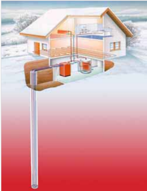
Bild 2: Sondenbohrung für flache Geothermie
