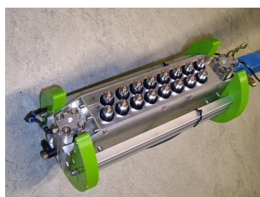
Ultraschall-Bohrlochsonde mit steuerbarem Schallfeld ("Phased Array"). BAM-Projekt "SealWasteSafe"
