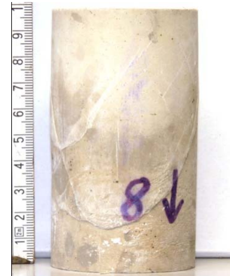
PK 8: Matrixentfestigung beim Bruch keine signifikanten Bruchhälften
