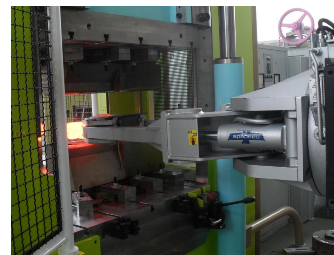
Flachsattel für Freiformschmieden mit Manipulator
