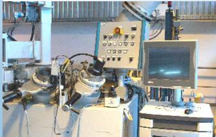
Steuer- und Kontrolleinheit der ALD-Anlage
