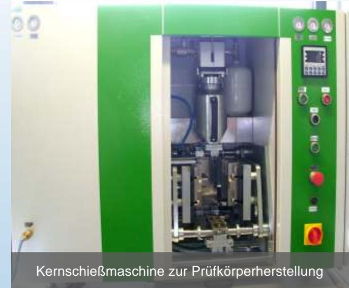
Kernschießmaschine zur Prüfkörperherstellung
