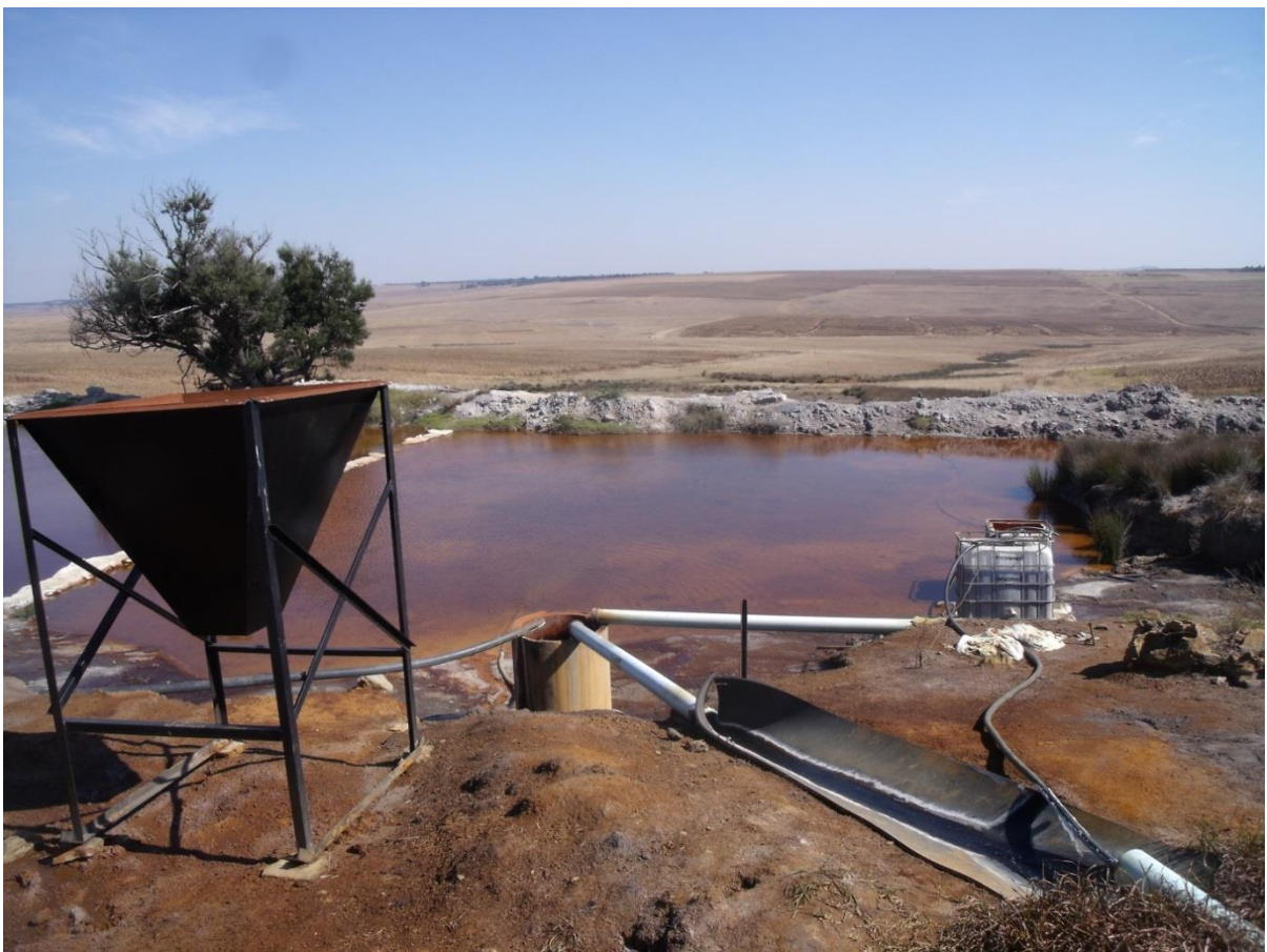
Abbildung 2: Ein künstlich angelegter Teich, der zu Forschungszwecken von aktiver und passiver Technologie zur Behandlung des austretenden Grubenwassers dient.
