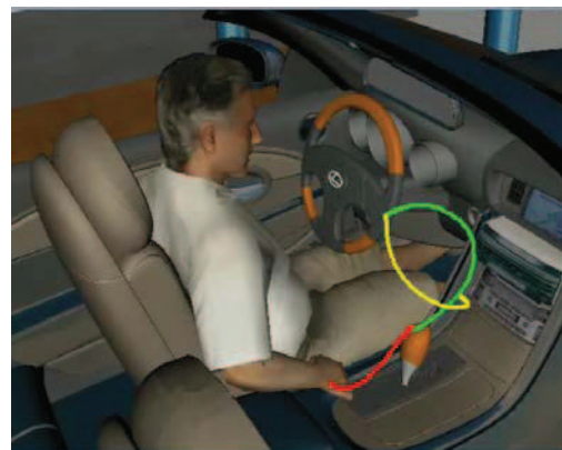
Abb. 2: Zur weiteren Erprobung werden Animationen mit virtuellen Testpersonen erzeugt, welche die vorgemachten Bedienungsvorgänge nachahmen.
