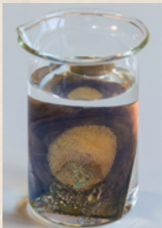
Entwickeln eines Fingerabdrucks durch Reduktion von Silberionen auf Messing
