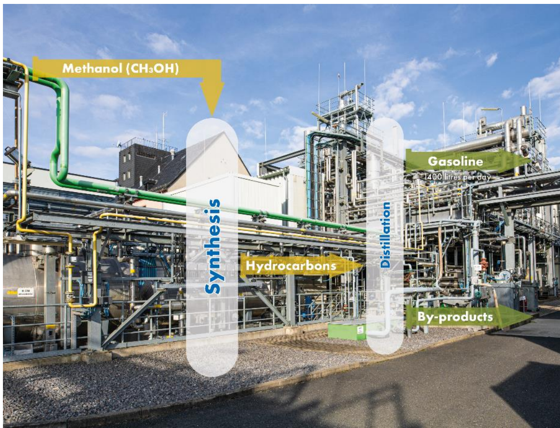
Methanol-to-Gasoline-Prozess in der Benzinsynthese-Großversuchsanlage
