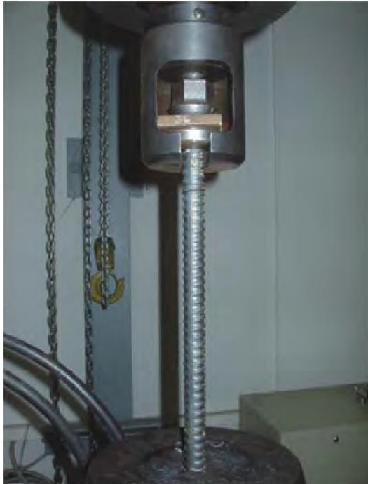
Fig. 6.1: Direct tension test of bolt (Frühwirt 2011)
