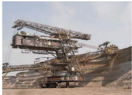
Schaufelradbagger im Bergbau-Tagebau
