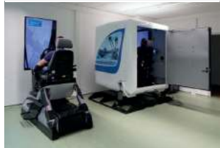
Baggersimulatoren für die Lehre (rechts: Kabinensimulator)
