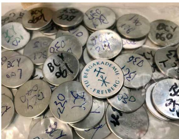
**Abbildung 6:** Im Rahmen der Masterarbeit von Yen-Ming Li gefertigte Knopfzellen
