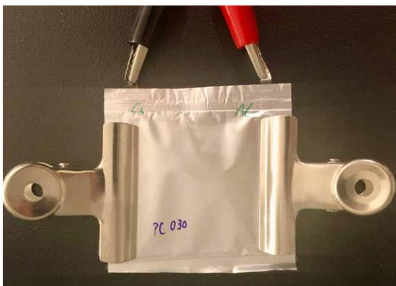
**Abbildung 1:** Pouchzelle mit gewebebasierten Elektroden zur Hochskalierung der mit Knopfzellen gewonnenen Ergebnisse
