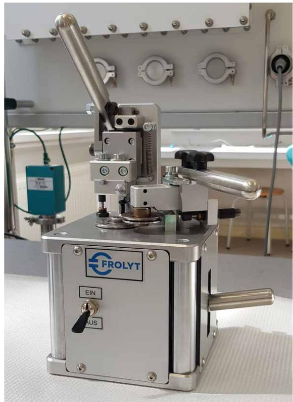
Vorrichtung zum Verschließen von Kondensatorgehäusen
