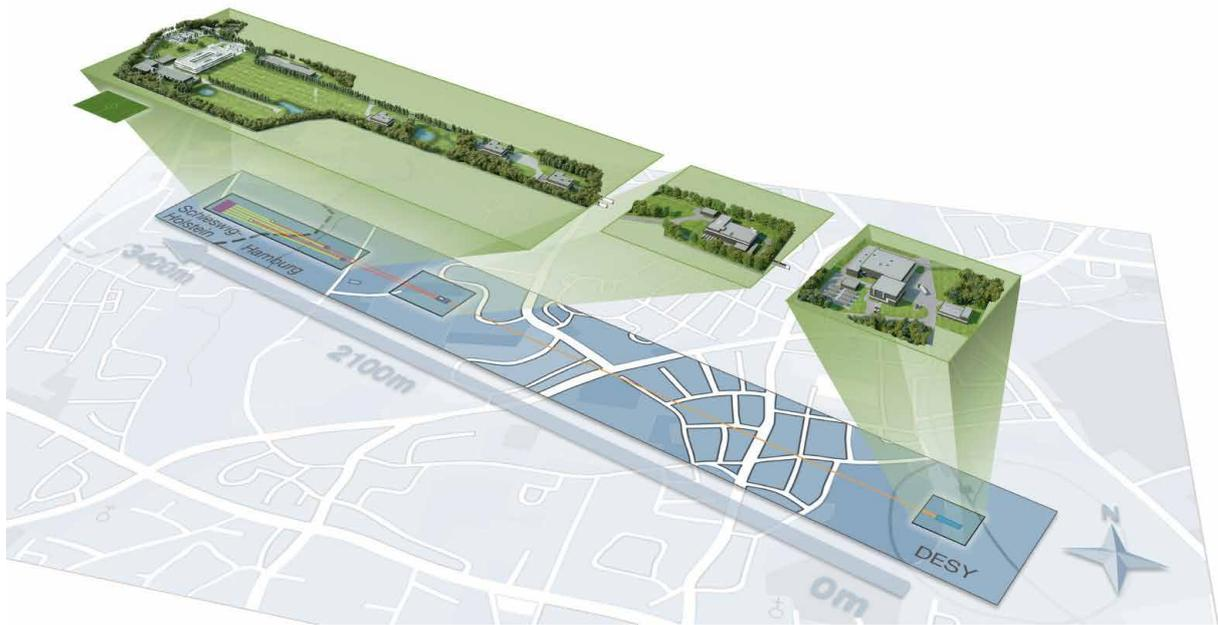
**Abbildung 4:** European XFEL mit den drei Betriebsgeländen Schenefeld (Experimentierhalle), Osdoerfer Born sowie DESY-Bahrenfeld: Die Gesamtlänge der Anlage beträgt 3,4 km (© European XFEL).
