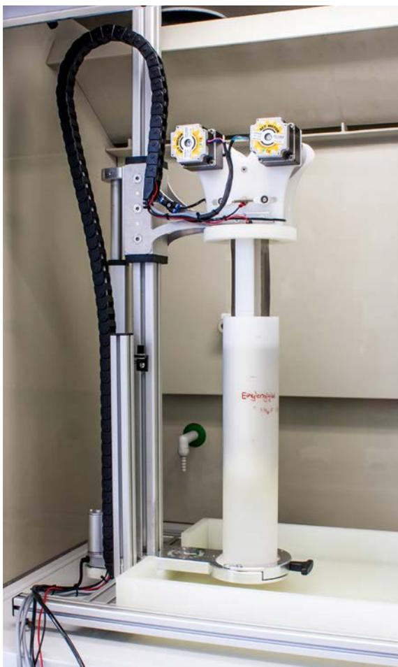
**Abbildung 3:** Bandanlage zur anodischen Oxidation von Metallfolien. Die Anlage ist auf Folienmaße von 5 cm x 100 m ausgelegt.
