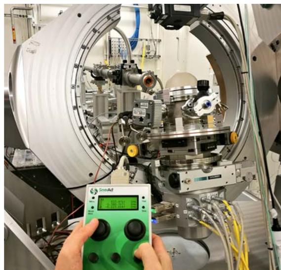
**Abbildung 2:** Durch die Positioniereinheit der Kontaktiernadel wurden ohne Öffnen der evakuierten Probenkammer verschiedene elektrische Kontakte angefahren und gemessen.
