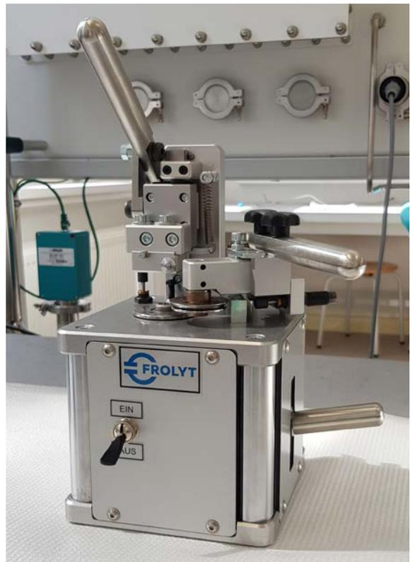
Vorrichtung zum Verschließen von Kondensatorgehäusen
