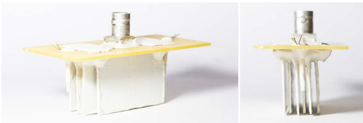
Abbildung 3: Realisiertes Demonstratorkonzept mit sechs isolierend beschichteten PZT-Platten
