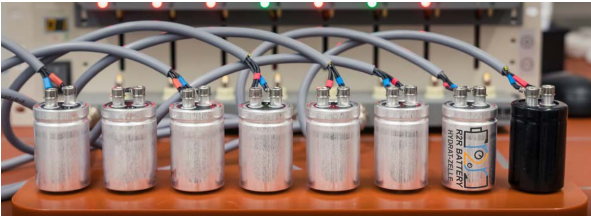
Abbildung 2: Batteriezellen mit Hydrat-Elektrolyt, die vom Partner Frolyt im Rolle-zu-Rolle-Prozess hergestellt wurden.
