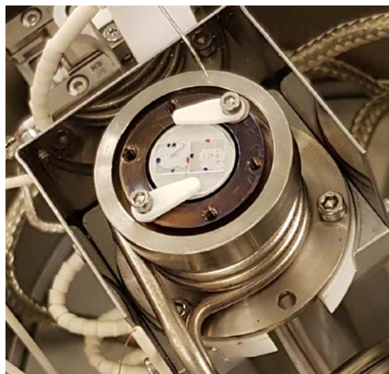
Abbildung 2: Um die Messzeit effektiv zu nutzen, wurden gleich zwei \text{LiTaO}_3 -Proben einjustiert, einmal stöchiometrisch und einmal kongruent.
