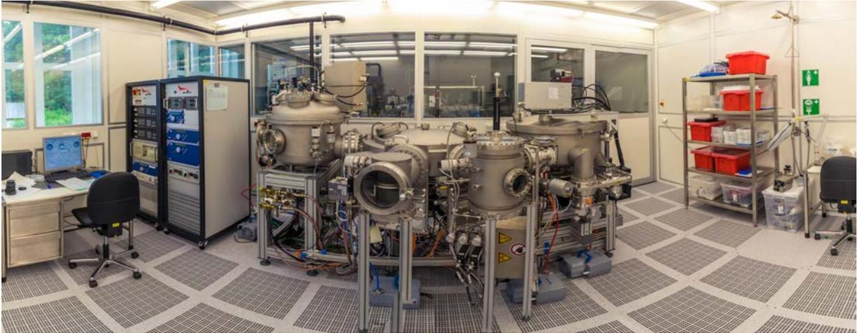
**Abbildung 1:** Blick auf die Magnetron-Sputteranlage im ZRL
