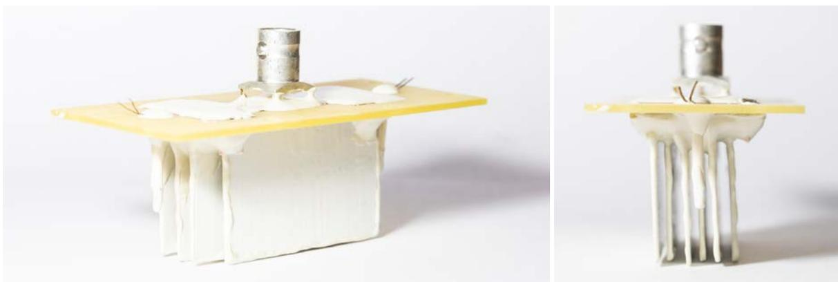
**Abbildung 3:** Realisiertes Demonstratorkonzept mit sechs isolierend beschichteten PZT-Platten
