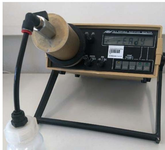
Messgerät zur Bestimmung der Radioaktivität einer Radon-Probe
