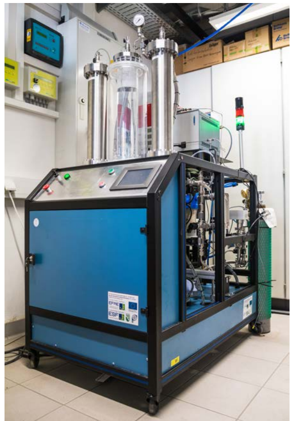
Demonstrator für die pyroelektrische Wasserstofferzeugung
