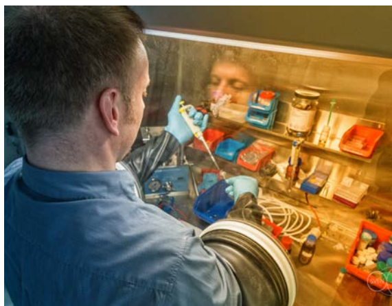
Abbildung 4: Dr. Tilmann Leisegang bei Arbeiten an einer Batteriezelle in der Glovebox
