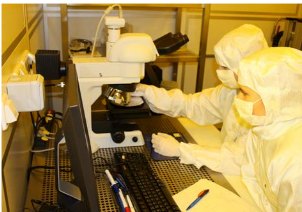
Abbildung 2: Die Resultate der Lithographie werden am Mikroskop im ZRL überprüft.
