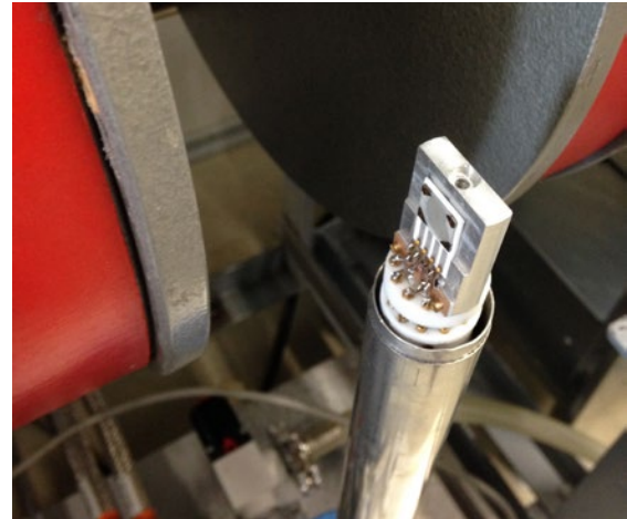
Abbildung 3: Kontaktierte GaN-Probe auf Probenträger. Im Hintergrund befinden sich die Hall-Magneten.
