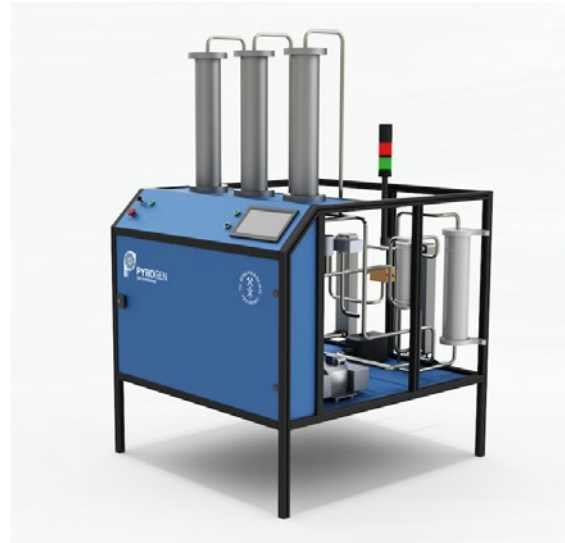
Abbildung 3: Demonstrator zur pyroelektrischen Wasserstoffherzeugung mit drei Zylindern zur Aufnahme des Aktivmaterials.
