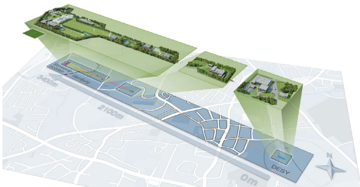
Abbildung 7: European XFEL mit den drei Betriebsgeländen Schenefeld (Experimentierhalle), Osdofer Born sowie DESY-Bahnhof. Die Gesamtlänge der Anlage beträgt 3,4 km (© European XFEL).
