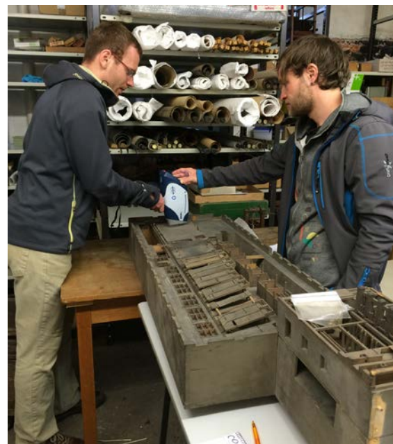
Abbildung 1: Bestimmung der chemischen Zusammensetzung an verschiedenen Modellen der Sammlung mithilfe des portablen RFA-Geräts durch Dipl.-Ing. (FH) Marco Herrmann und B. Sc. Thomas Naumann.
