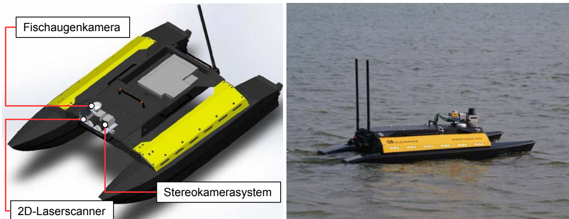
Abbildung 3: Das robotische Boot Elisabeth ermöglicht die Datenerfassung in gefluteten Bergwerksbereichen.
