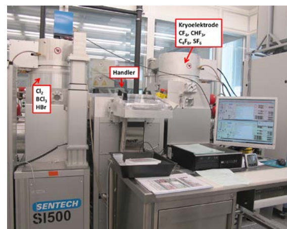
Abbildung 3: Plasmaätz-Clusteranlage mit zwei Kammern mit induktiv gekoppelten Plasmaquellen für das Trockenätzen. Plasmaätzen mit fluor- und chlorhaltigen Gasen wird jeweils getrennt in einer dedizierten Kammer durchgeführt.
