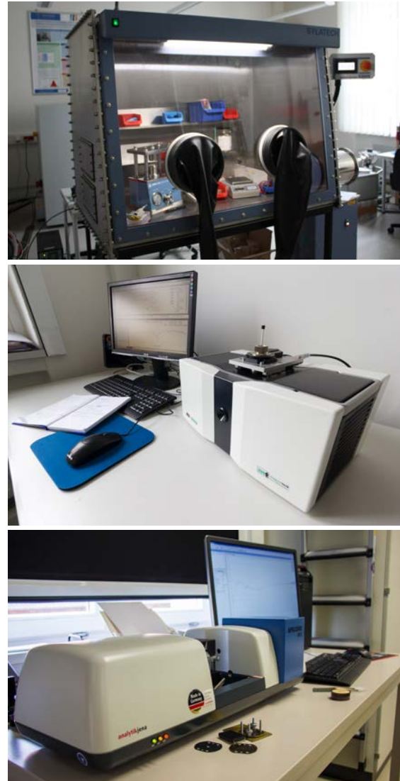
Abbildung 8: In Betrieb genommene Geräte: Argon-Glovebox (oben), Elektronenspinresonanzspektrometer MS 5000 (Mitte) und UV/Vis-Spektrometer Specord S600 (unten).
