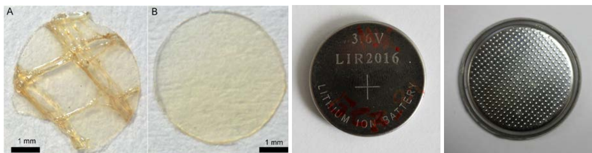
Abbildung 1: Verschiedene Materialkonzepte. Links: Gel-Membran auf Basis von Chitin/Chitosan [RSC Advances 6 (2016) 4007]. Mitte und rechts: In Knopfzellen verpackte Na-S-/Si-Komposit-Anodenmaterial-Zellen.
