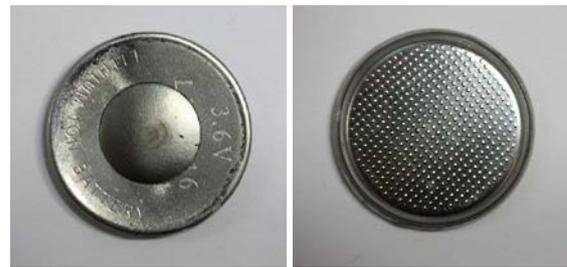
**Abbildung 2:** Batteriezelle mit Al-beschichtetem Kapton-Fenster für *In-operandi*-XRD-Messungen: Kathode (links), Anode (rechts).
