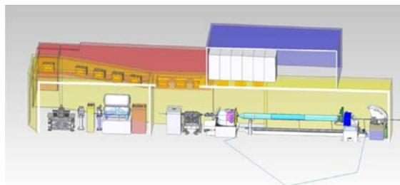
Abbildung 6: Seitenansicht der MID-Hütten. In den Experimentierhütten zu erkennen ist das MID-Instrument mit einem großen Detektorarm. Eine optische Laserhütte ist rot skizziert. Die blaue Hütte auf dem Dach der Experimentierhütte enthält Elektronikschränke.
