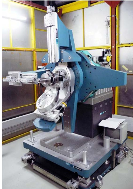
**Abbildung 2:** Das neue Kappa-Diffraktometer der *Chemical Crystallography Beamline* wurde bereits in der ehemaligen DORIS-Halle getestet.
