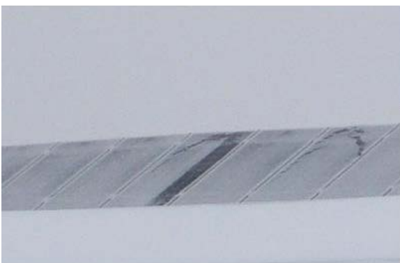
Lokal schmelzender Schnee als Indikator einer erhöhten Betriebstemperatur in einer Solarzellenreihe innerhalb der Solarmodule.
