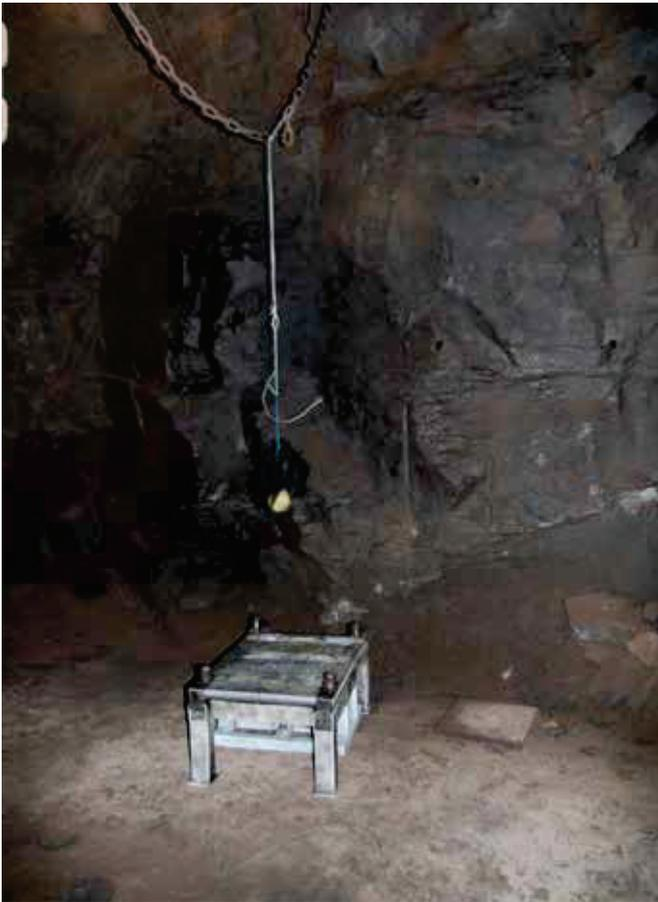
Abb. 21: Versuchsaufbau für einen Schockwellen-Test einer Sandwich-Sicherheitsstruktur. Der Sprengstoff befindet sich oberhalb der Platte.
