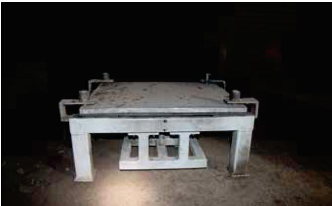
Abb. 22: Sandwich-Sicherheitsstruktur nach dem Explosionstest.
