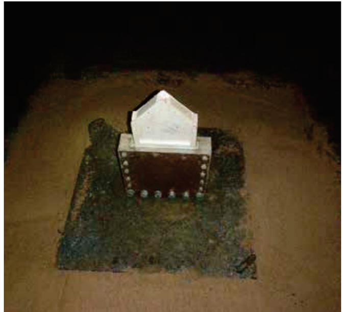
Abb. 23: Versuchsaufbau eines Line-Wave-Generators für Material- bzw. Gesteintest (Breite 400 mm).
