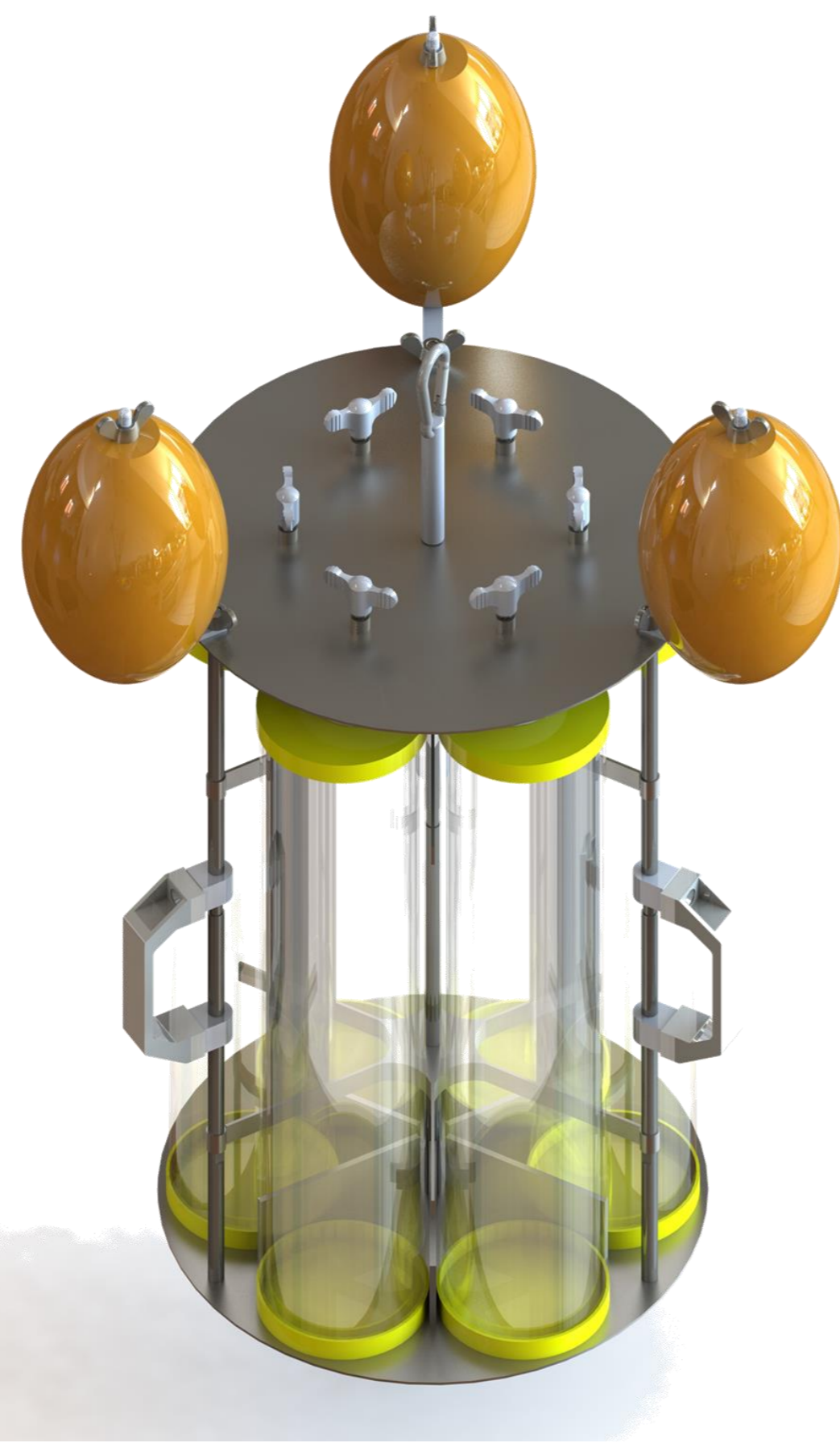
Konstruktionsmodell und Umsetzung des UWTT mit Schwimmkörpern
