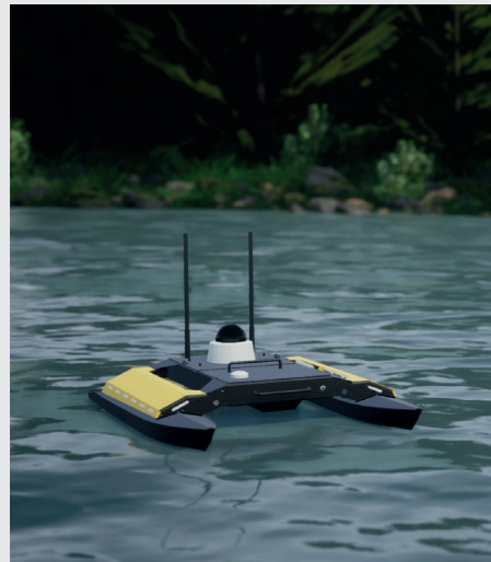
Bild 1 Der Schwimmroboter „Elisabeth“ der TU Bergakademie Freiberg soll mit einem komplexen Sensorsystem für das Gewässermonitoring ausgestattet werden. Quelle: TU Bergakademie Freiberg
