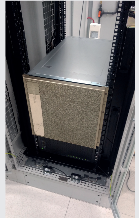
Bild 5 KI-Rechner NVIDIA DGX2 des Instituts für Informatik an der TU Bergakademie Freiberg. Quelle: TU Bergakademie Freiberg
