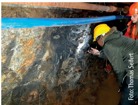
Abb. 22: Bemusterung eines Lamprophyr-Dikes (Typ LD1 – prä-monzogranitisch) während des Kartierungspraktikums Teil 2. Besucherbergwerk Zinngrube Ehrenfriedersdorf, 2. Sohle.
