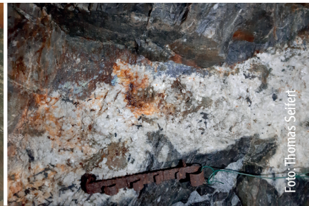
Abb. 21: Pneumatolytische Quarz-Wolframit-Kassiterit-Molybdänit-Mineralisation, Leimgrübler-Morgengang Nord, Besucherbergwerk Zinngrube Ehrenfriedersdorf, 2. Sohle.
