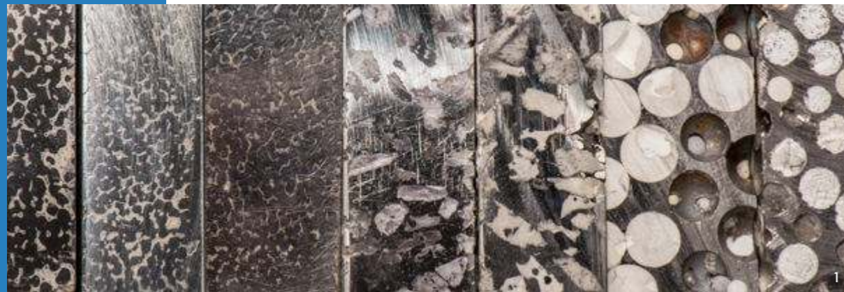
1 Mit Stahl infiltrierte Gusskörper, TP S1
