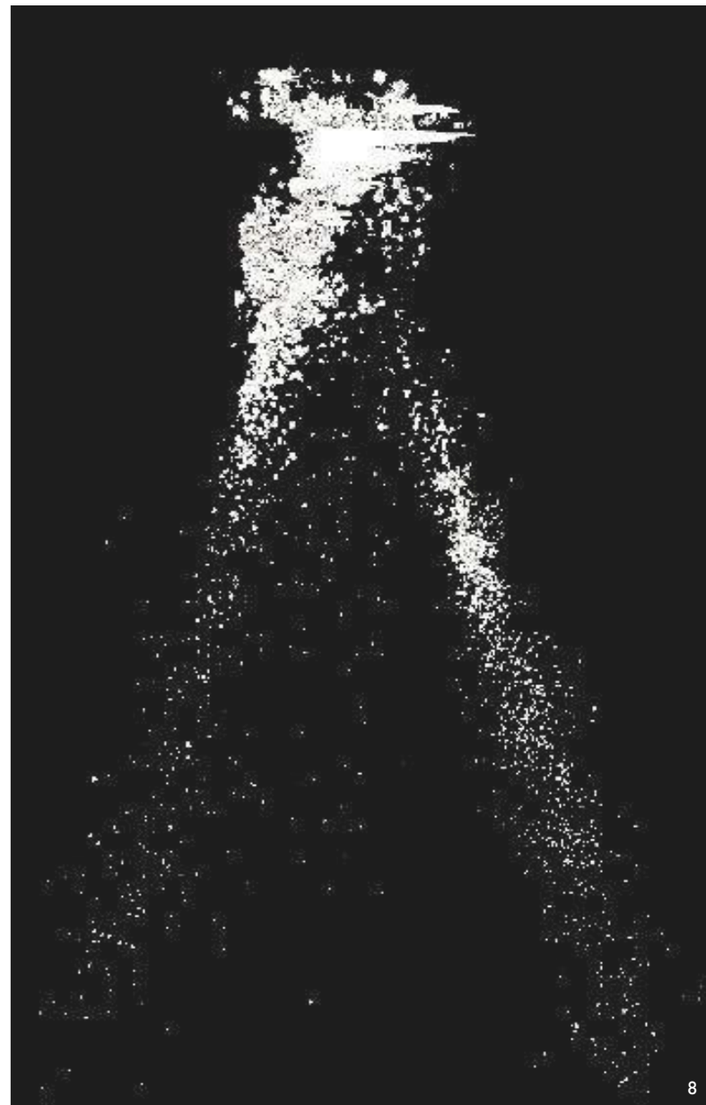
1 Versinterte Kugelmakrostruktur, TP A1 | 2 Mit Stahl infiltrierte Gusskörper, TP A4/S1 | 3 Wabenkörper, TP A5 | 4 Ballotines, TP A1 | 5 Probe mit EB-Schweißnaht, TP A7 | 6 Maximalblasendruckanlage, TP A2 | 7 Pulvermetallurgisch erzeugte radial gradierte Probe, TP A6 | 8 Aufnahme von Stahltropfen mittels Particle-Image-Velocimetry (PIV) während des Verdünnungsprozesses, TP A3
