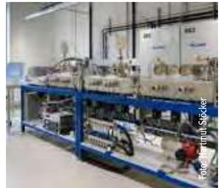
Kombinierte Anlage für die Fertigung von Batteriekomponenten unter Vakuumbedingungen
