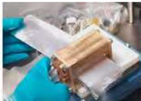
Experimenteller Kalandrier zur Fertigung von Dünnschicht-Feststoffelektrolyten: Der Polymerelektrolyt wird zwischen zwei erhitzten Folien zu einer glatten Schicht ausgewalzt.
