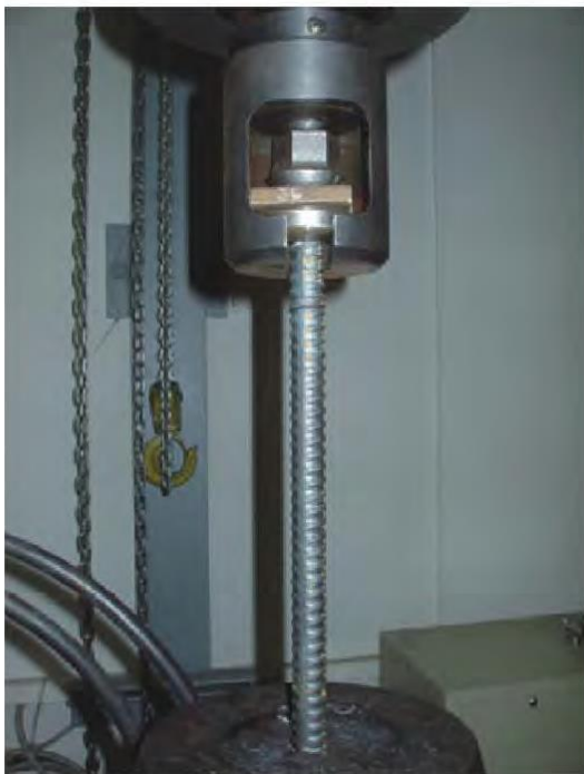
Fig. 6.1.: Direct tension test of bolt (Frühwirt 2011)
