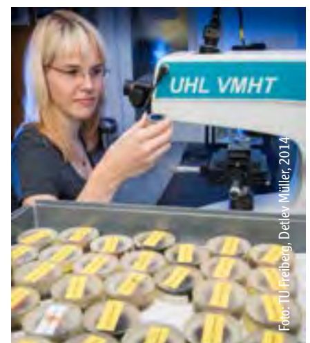
Abb 1: Mikroskopische Untersuchung von Körnerschliffen am Forschungsmikroskop und dem Mikrohärteprüfer.
