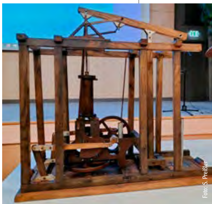
Zur Vorbereitung der Rekonstruktion der Brendelschen Dampfmaschine fertigte der Verein ein Modell im Maßstab 1:10
