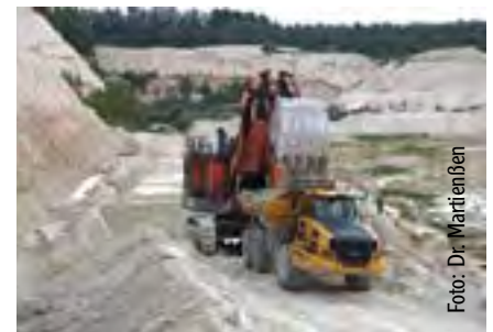
Abb. 4: Hydraulikbagger Hitachi EX1900 (190 t) bei der Gewinnung mit Dumper Bell B40 zur Förderung
