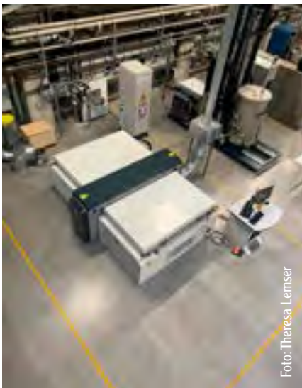
Anlage für das Recycling von Solarzellen unter Einsatz von FLA
