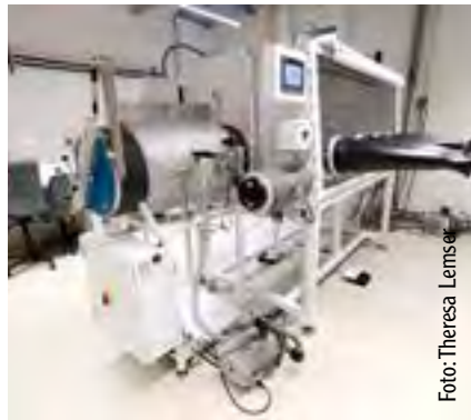
Glovebox für die Assemblierung von Knopf- und Pouchbatteriezellen unter Schutzgasatmosphäre
