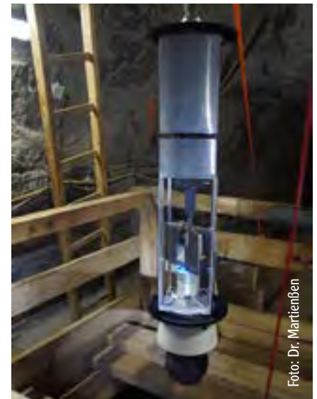
Abb. 11: Die über dem Bohrloch hängende Kavernenmesssonde vor dem Start der Vermessungsbefahrung
