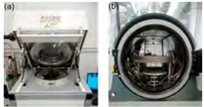
Abb 3: Geräte im Zentralen Reinraumlabor (ZRL) (a) Annealsys AS-One, Anlage zur Temperung von Proben (b) Probenkammer der ALD-Anlage Beneq R2.
