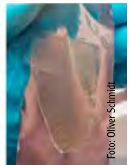
Experimenteller Kalender zur Fertigung von Dünnschicht-Feststoffelektrolyten: Der Polymerelektrolyt wird zwischen zwei erhitzten Folien zu einer glatten Schicht ausgewalzt.
