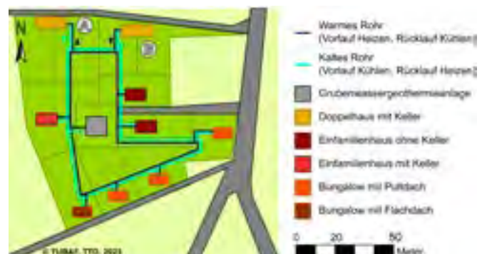
Abb. 3: Schematische Darstellung eines möglichen kalten Nahwärmenetzes für das Modellquartier
