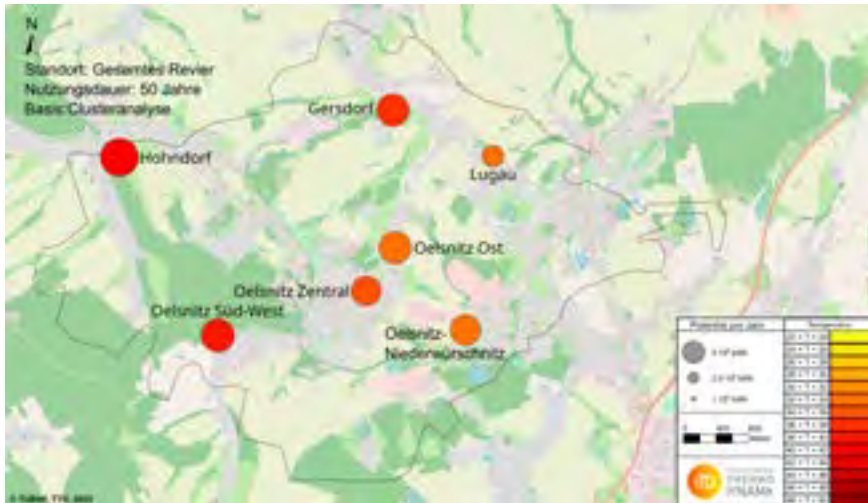
Abb. 4: Potenzialbetrachtung (jährlich entziehbare Energiemenge) für 50 Jahre im gesamten Revier ausgehend von der vom DBI GUT durchgeführten Clusterbildung
