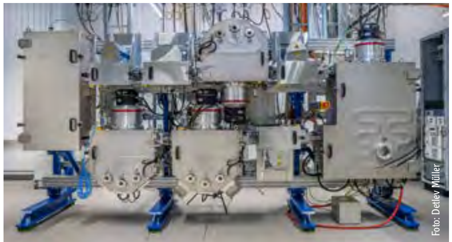
Anlage, hergestellt durch die Firma ROVAK, für die Erzeugung von Batteriekomponenten Rolle-zu-Rolle
