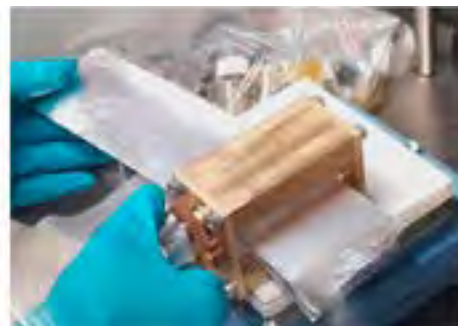
Experimenteller Kalender zur Fertigung von Dünnschicht-Feststoffelektrolyten: Der Polymerelektrolyt wird zwischen zwei erhitzten Folien zu einer glatten Schicht ausgewalzt.
