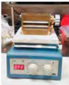
Experimenteller Kalender zur Fertigung von Dünnschicht-Feststoffelektrolyten: Der Polymerelektrolyt wird zwischen zwei erhitzten Folien zu einer glatten Schicht ausgewalzt.
