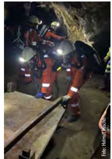
Abb. 5: Sicherung des Trupps an einer Leine aufgrund von Rauchentwicklung und Beräumung des Fahrwegs.
