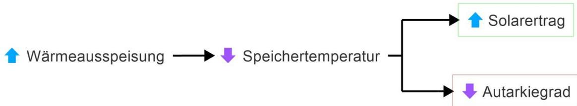
Abb. 6.59: Wirkungskette in Folge einer hohen Wärmeausspeisung
