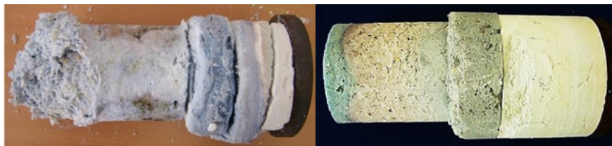
Abbildung 7: links: REFRAZIRCON Z AR von 2013, rechts: REFRAZIRCON Z AR von 2015 Jeweils nach 9 Zyklen im Gradientenofen, von links nach rechts: 1050°C heiße Seite des REFRAZIRCON Z AR mit 60 bzw. 80 mm, weißer Wärmedämmstoff SILCAL 1100, dunkle Stahlronde mit einer Temperatur von 150°C.
