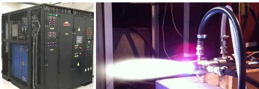
Abb. 1: Anlage MGS50 des Herstellers Plazarium GmbH (links); Plasmabrenner mit einer elektrischen Leistung von 80 kW und O_2 -freien Arbeitsgasen (rechts), Fotos: Institut für Energieverfahrenstechnik und Chemieingenieurwesen
