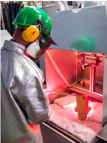
Abb. 1: Arbeiten am Tiegelofen Quelle: Detlev Müller
