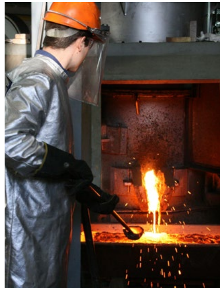
Abb. 2: Abstich an der TSL-Badschmelzanlage Quelle: INEMET
