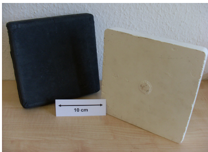
Abb.5: Druckschlickergegossene kohlenstoffgebundene Platte (links) und oxidische Platte (rechts)
