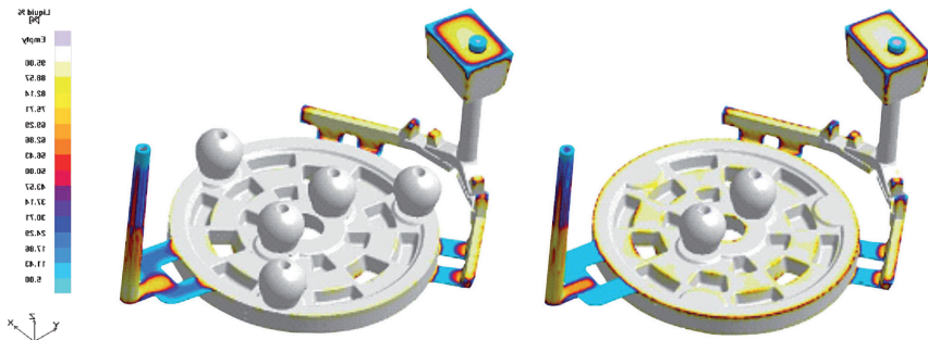
Abb. 6: Die ursprüngliche Gießtechnik für das Zahnrad sieht 5 Speiser pro Teil vor (linkes Bild), mit optimierter Gießtechnik sind nur noch 2 Speiser pro Teil nötig (rechtes Bild).
