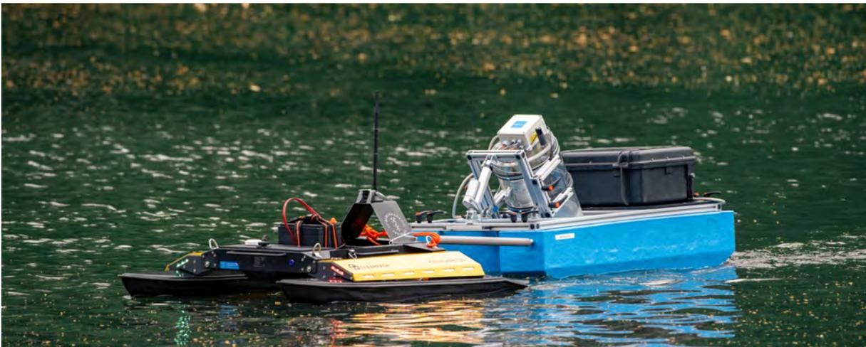
*Das robotische Boot Elisabeth dient hier als Zugmaschine für den Prototyp der modularen Plattform „Ferdinand\_01“, hier mit einem SEMACH-FG-System zur Messung der Gewässerrespiration*
