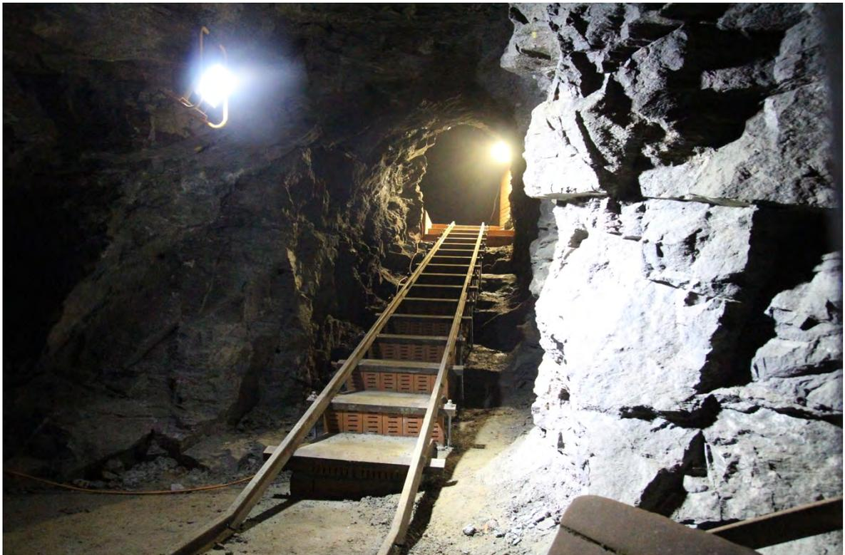
*Neuer SWL-Zugang. Durch die eingebauten Gleise können nun Proben von der Grubenbahn direkt auf einen Wagen geladen und bis zum Sprengort transportiert werden. Dies ermöglicht Versuche mit großen und schweren Proben (Sprengplattieren, Gesteinstest) bzw. ganzen Bauteilen (Sicherheitsprüfung). (Foto: G. Heide)*
