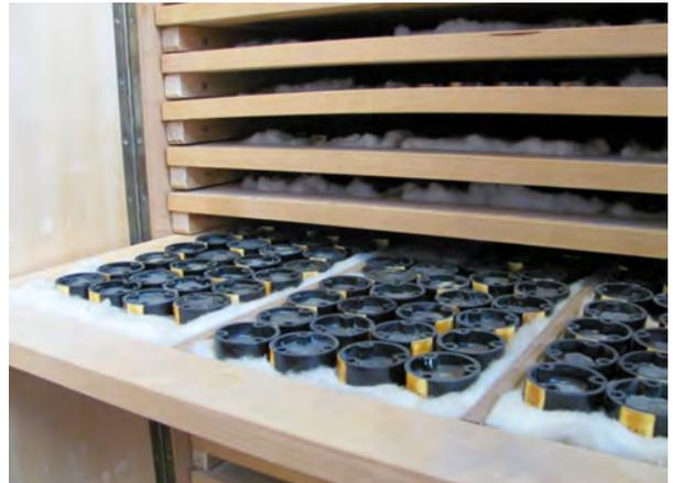
**Links:** Mineralogische Qualifizierungsarbeiten. **Rechts:** Ringanschliffe der Erzanschliffsammlung
