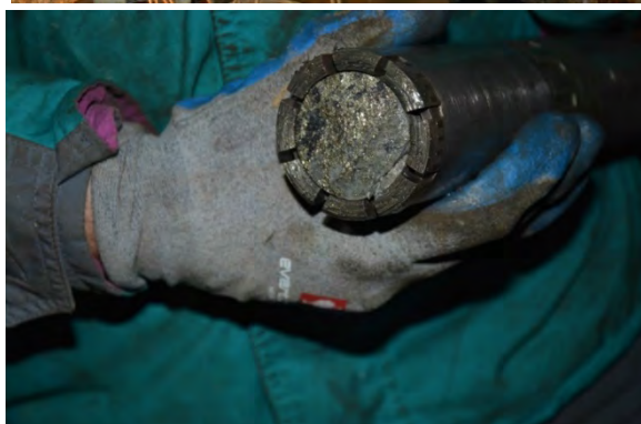
TP 1: Links oben: Bohrarbeiten; Rechts oben: Durchstoß der ersten 8 m langen Kernbohrung in die Liegendstrecke; Unten: Gewinnung (l) und Dokumentation (r) der gewonnenen Kernproben
