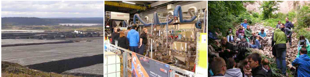
Links: Aufhaldungen des Graphit-führenden Ni-Cu-Zn-Pb-Erzes zur bakteriell unterstützten Laugung; Talvi-vaara-Mine, Nordfinnland. Die Befahrung der Mine war ein Programmpunkt des ProMinNet-Workshops an der Universität Oulu mit Beteiligung der AG Lagerstättenlehre und Petrologie. Mitte: Flotations-Versuchsanlage (Minipilot-Plant) der Oulu Mining School mit Teilnehmern des ProMinNet-Workshops beim Durchführen einer praktischen Übung. Rechts: Oliver Frei mit Studierenden des 4. Semesters BGM beim Geländepraktikum Mineral- und Gesteinsbestimmung 2013 (Granitsteinbruch im Massiv von Meissen, rechts der Elbe; Fotos BS)
