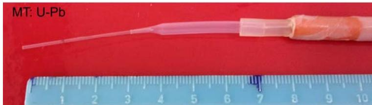
Links: Selbst hergestellte Pipette zu Ladeblank-Bestimmungen und zum Spiken. Die Pipette besteht vorn (=links) aus Schrumpf-Teflon mit aufgesetzter speziell gereinigter Teflonkapillare (sog. „Spaghetti“, ca. 1 mm Durchmesser). Der Eichstrich bei 1 cm Länge entspricht 2,75  $\mu$ L Spike.
