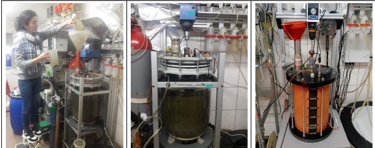
Abb. 24: Durchführung von Biogasversuchen zur anaeroben Fermentation von oberirdischem Aufwuchs von Rohrglanzgras ( Phalaris arundinacea ) im Labor des Instituts für Wärmetechnik und Thermodynamik der TU Bergakademie Freiberg.
