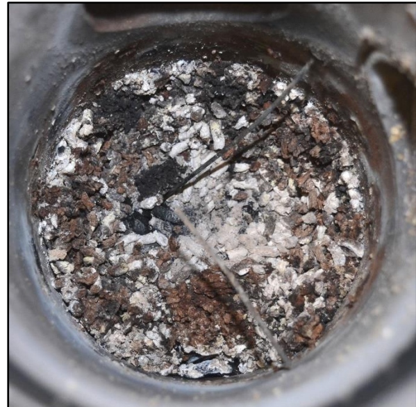
Holzpellets nach der Umwandlung im Vergaser in einem Versuchsreaktor
