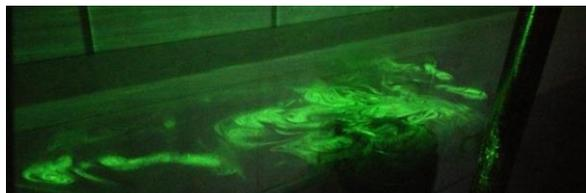
**Abb. 1:** Aufbau eines klassischen PIV-Systems (oben); Tracerpartikel (hier Nebelfluid) im Horizontallichtschnitt (unten)
