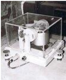
Kurzperiodisches Seismometer der Bauart VSJ-II, das bis 1995 in Berggießhübel eingesetzt wurde
