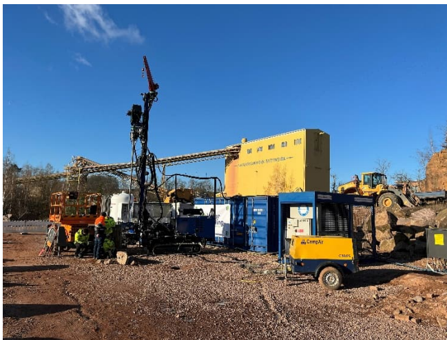
Abbildung: Einsatz des neu entwickelten Laser-Bohrverfahrens in einem Granitsteinbruch in Sachsen; Setup der Bohrtechnik (links) und Laserprozess (rechts)
