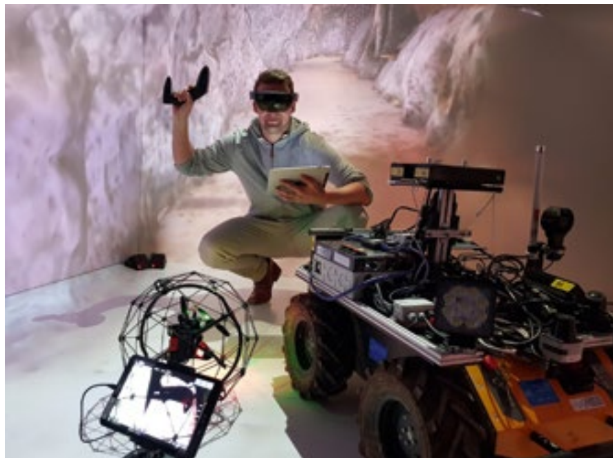
Abb. 3: Evaluierung von Sicherheitsaspekten beim Einsatz von Drohnen und Robotern unter Tage im virtuellen Bergwerksmodell
