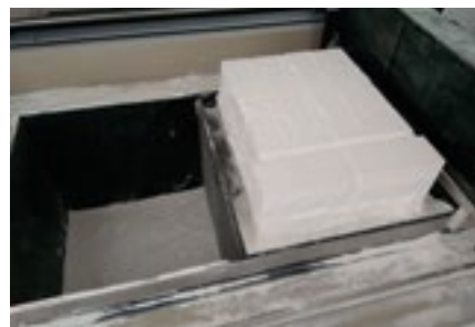
Abb. 5: Gedruckte Bauteile auf der Bauplattform vor dem „Auspacken“; links ist die leere Pulvervorratskammer sichtbar
