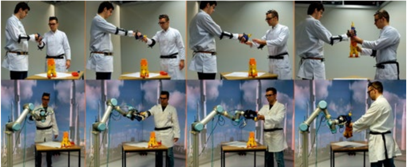
Abb. 3: Die obere Zeile der Abbildung zeigt, wie Zwei-Personen-Interaktionen mittels Motion Capture aufgezeichnet werden. Nach der Berechnung des Interaktionsmodells kann ein Roboter mit einem menschlichen Nutzer in ähnlichen Situation interagieren. Seine Bewegung wird dabei dynamisch zu jedem Zeitpunkt neu angepasst, sodass Objekte (wie eine Lego-Rakete) filigran zusammengebaut werden können.
