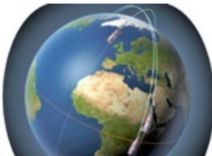
Abb. 1: Illustration der „Swarm“-Konstellation aus drei Satelliten zur Messung des Erdmagnetfeldes (Bildursprung: ESA)
