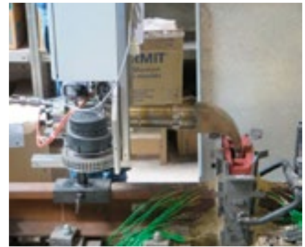
Abb. 11: Schweißversuche und Temperaturverteilungsmessungen mit dem Modul-Prototypen 1
