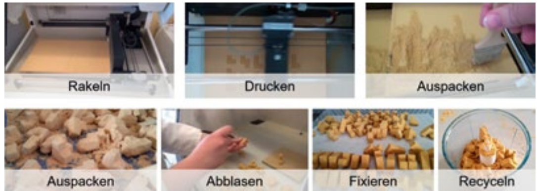
Abb. 14: Prozesskette des 3D-Druckens von Produkten aus Aprikosenkernmehl [AMtopus GmbH & Co. KG]
