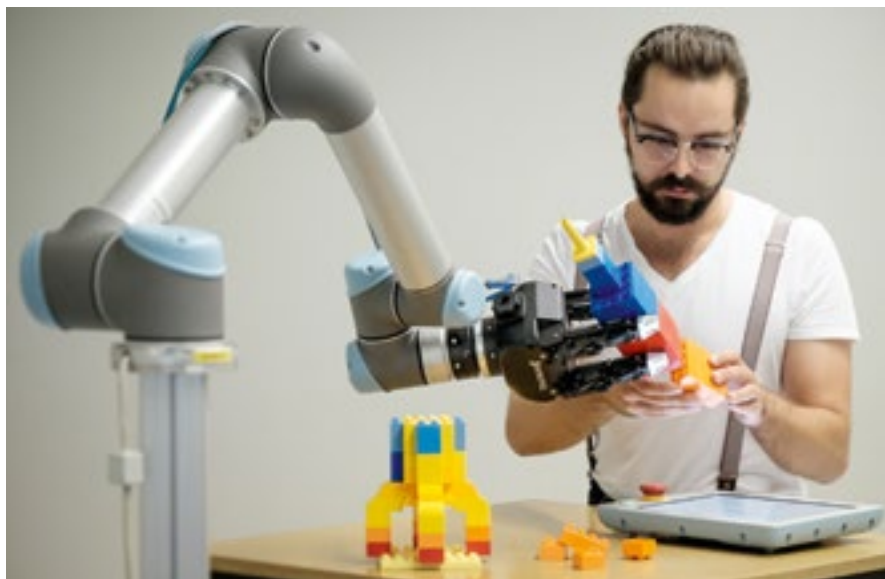
Abb. 1: Ein Roboterarm reagiert kontinuierlich auf Bewegungen des Menschen und reicht mit einer dynamisch angepassten Bewegung Werkstücke. Das Ergebnis ist eine für den Mensch natürliche und intuitive Interaktion.
