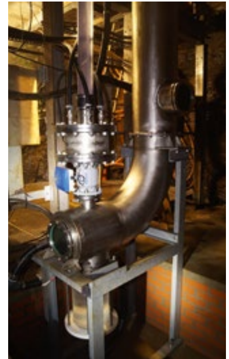
Abb. 3: Funktionsfähige Labor-Airliftanlage im Lehr- und Forschungsbergwerk „Reiche Zeche“
