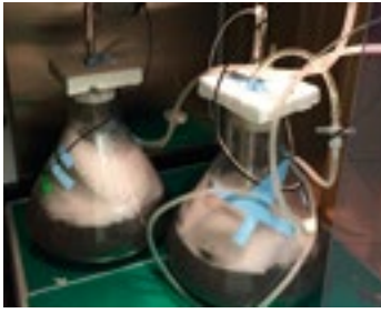
Abb. 2: Synthese von 3-Hydroxytyrosol im Maßstab von 1,5 L in Schüttelkolben
