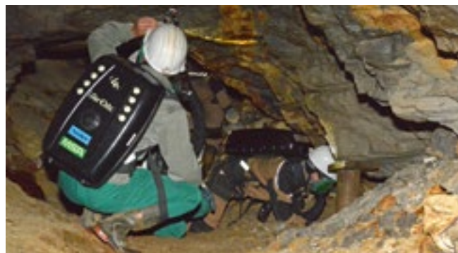
Abb. 4: Ein autonomer Untertage-Roboter sammelt eine Vielzahl von wichtigen Bergbaudaten, die sofort genutzt werden können
