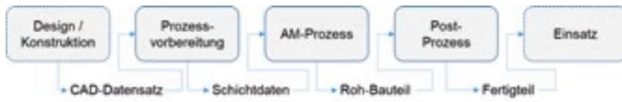
Abb. 3: Prozesskette der Additiven Fertigung
