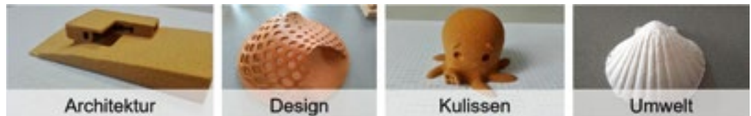
Abb. 15: Beispiele für 3D-gedruckte Teile aus v.l.n.r. Aprikosenkernmehl, Miscanthus, Aprikosenkernmehl, Muschelkalk
