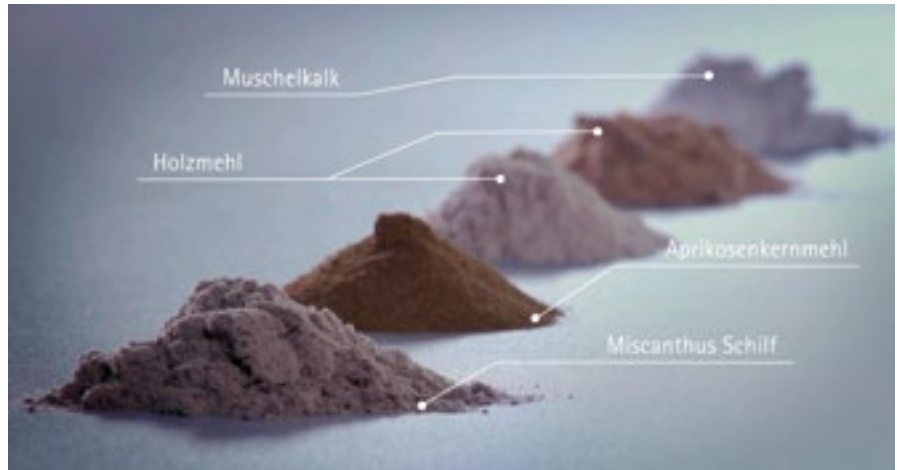
Abb. 11: Ausgangsmaterial für das 3D-Drucken [AMtopus GmbH & Co. KG]
