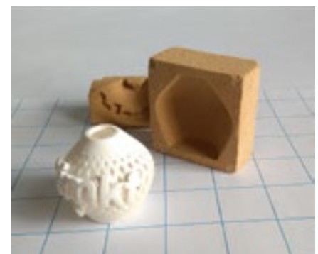
Abb. 13: Bauteil und 3D-gedruckte Verpackung aus Miscanthus
