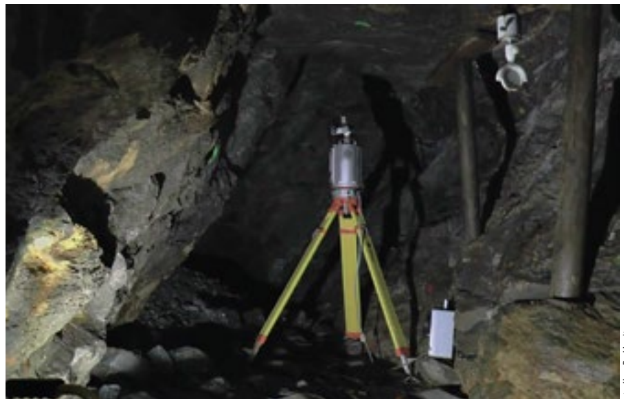
Abb. 2: Aufnahme an der Ortsbrust mit kombiniertem Laserscanning-Kamera-System
