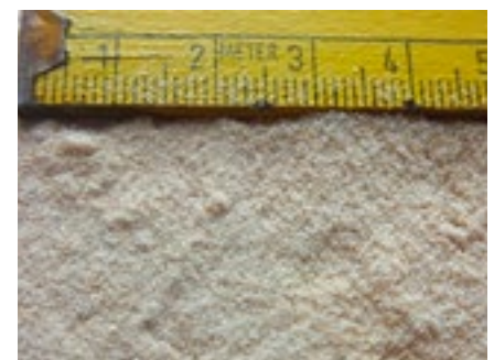
Abb. 8: für den 3D-Druck gesiebte Miscanthuspartikel
