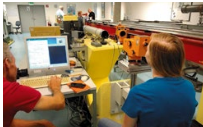
Bestimmung des Ziellinienfehlers und der Kompensator-Ablaufkurve
