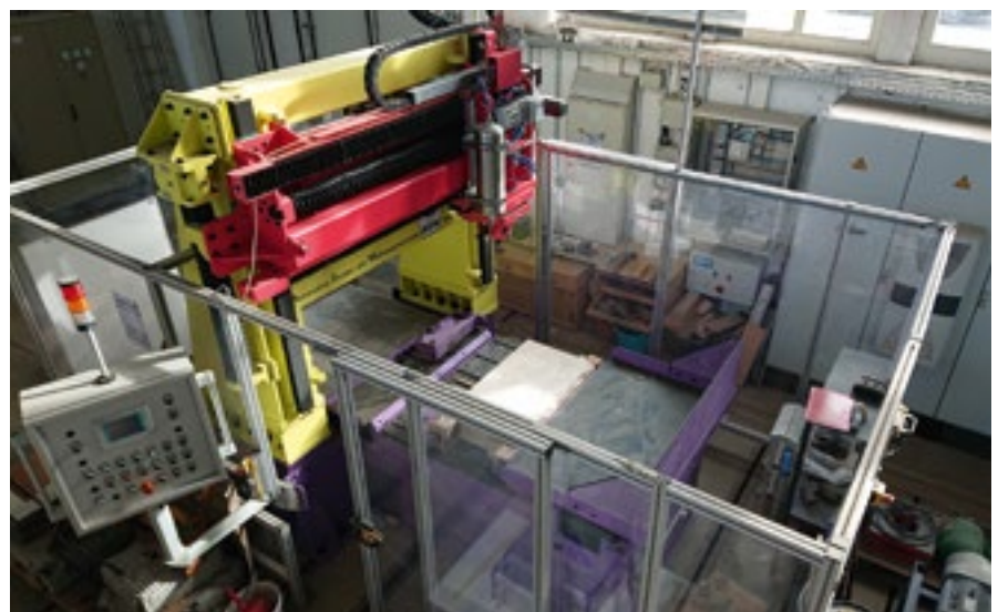
Abb. 4: Linearer Schneidprüfstand HXS1000-50 an der TU Bergakademie Freiberg
