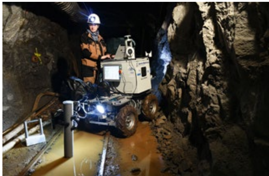
Abb. 4: Ein autonomer Untertage-Roboter sammelt eine Vielzahl von wichtigen Bergbaudaten, die sofort genutzt werden können
