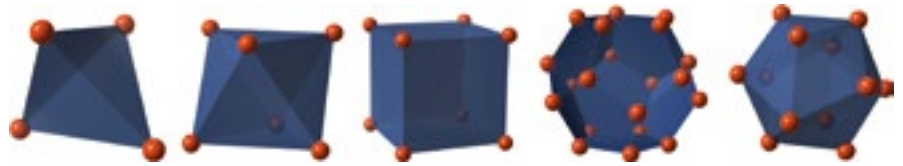
Abb. 1: Platonische Körper mit zunehmender Symmetrie, d. h. Anzahl an Symmetrieelementen: der Tetraeder, der Oktaeder, der Würfel, der Dodekaeder und der Ikosaeder
