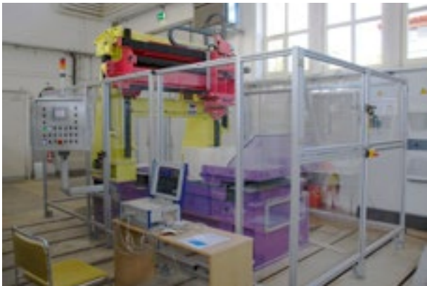
Abb. 6: Schneidversuchsstand in der Versuchshalle
