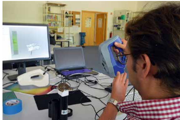
Abb. 6: A) Ilja Kogan digitalisiert mit einem Streifenlichtscanner den Schädel des reptiliomorphen Amphibs Madygenperpeton pustulatum . B) Einige photogrammetrisch digitalisierte Leitfossilien, wie diese mesozoische Muschel Trigonia , wurden versuchsweise in das Lernportal OPAL geladen.
