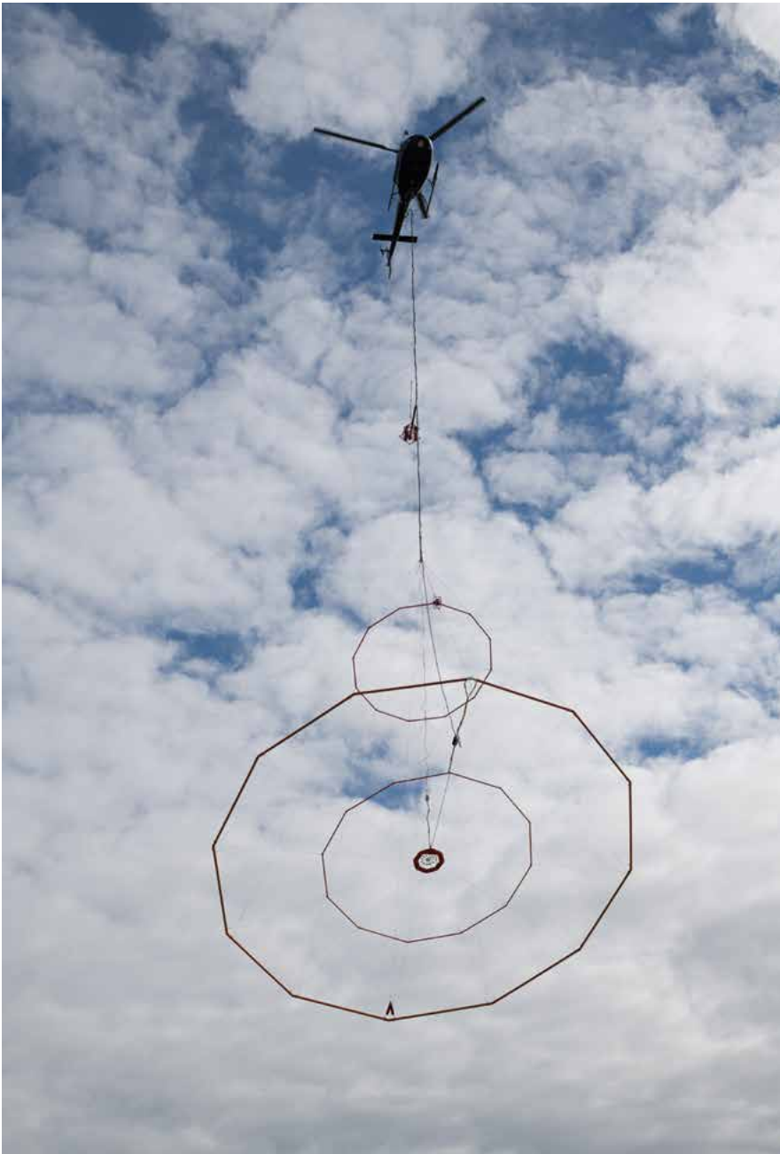
Abb. 1: Datenerfassung der Hubschrauber-Elektromagnetik als Referenztechnik
