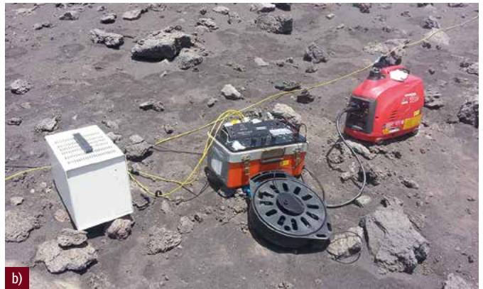
Abb. 3: Messkampagne am Stromboli im Juni 2019: a) TEM-Empfänger am Vulkankegel, b) TEM-Sender und c) aktive Vulkankrater in der Dämmerung
