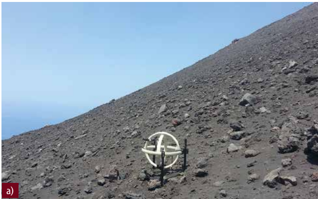
Abb. 3: Messkampagne am Stromboli im Juni 2019: a) TEM-Empfänger am Vulkankegel, b) TEM-Sender und c) aktive Vulkankrater in der Dämmerung
