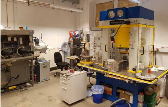
Abb. 1: Labore des Freiburger Hochdruckforschungszentrums (FHP). (a) 1000-t-Hochdruckpresse mit verschiedenen Modulen (Multi-anvil Walker-Modul und Toroid-Modul), (b) Sprengkammer des untertägigen Schockwellenlabors, errichtet mit Mitteln der Dr.-Erich-Krüger-Stiftung
