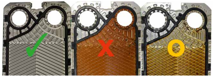
Abb. 5: Gegenüberstellung einer neuen (links), verschmutzten (mittig) und gereinigten (rechts) Wärmeübertragerplatte
