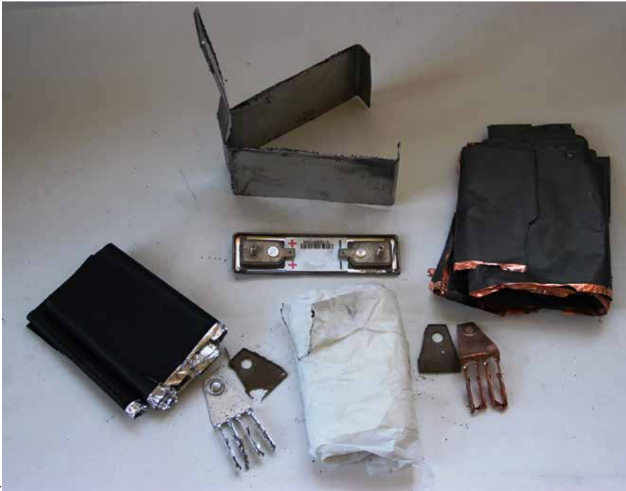
Abb. 1: Demontierte Komponenten einer ca. 1.700 g schweren prismatischen Einzelzelle aus einem Elektroauto
