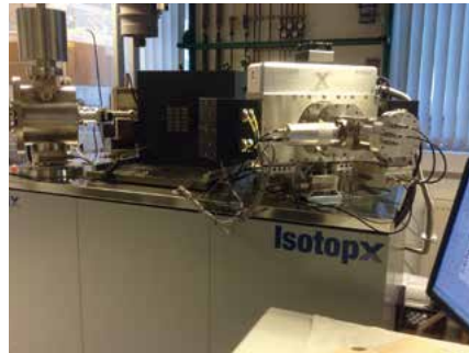
Abb. 1: Thermoionen-Massenspektrometer im Freiburger Isotopenlabor, Baujahr 2018. Dieses Gerät wird z. B. für die hochpräzise Altersbestimmung von Gesteinen eingesetzt.
