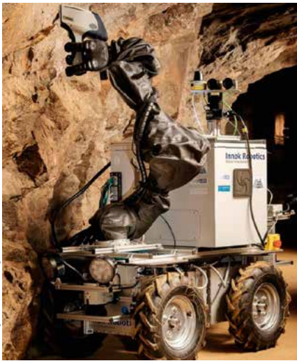
Bergbauroboter Julius beim einer Messung mit einem RFA-Handgerät unter Tage
